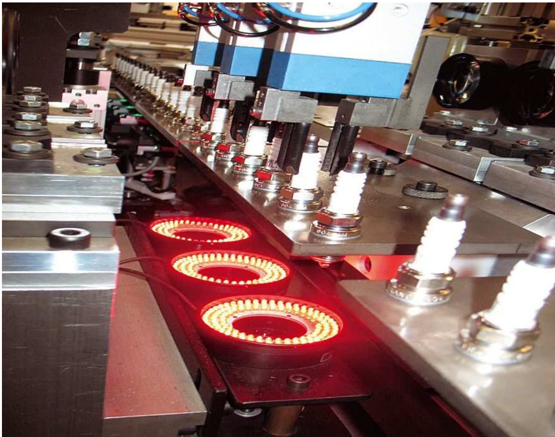
Pohled na montážní linku se „zapékáním“ keramického izolátoru do těla svíčky
